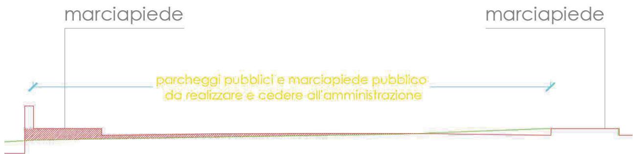
Figura 12 – In tratteggio rosso il riporto da realizzare per parcheggio pubblico, la cui area in sezione è 0.7 mq, che sarà compensato mediante sovradimensionamento della rete fognaria
